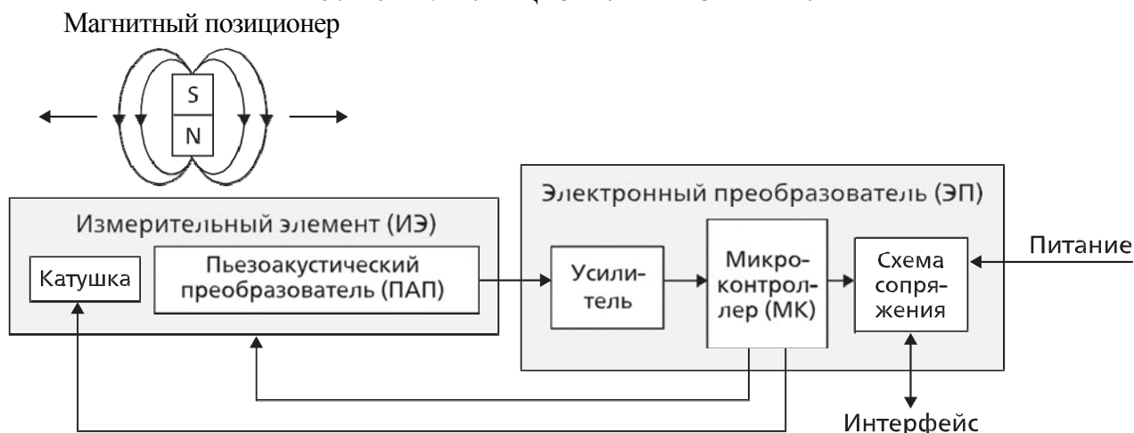
РИСУНОК 1. ФУНКЦИОНАЛЬНАЯ СХЕМА ПЛП
