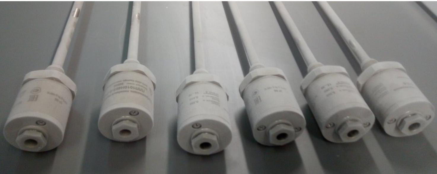
Работа магнитострикционных преобразователей линейных перемещений “ТрейсЛайн” заключается в непрерывном автоматическом измерении линейного расстояния от начальной точки отсчета до одного или нескольких подвижных позиционеров, с последующим преобразованием величины линейного перемещения в электрические сигналы стандартных аналоговых или цифровых интерфейсов.
